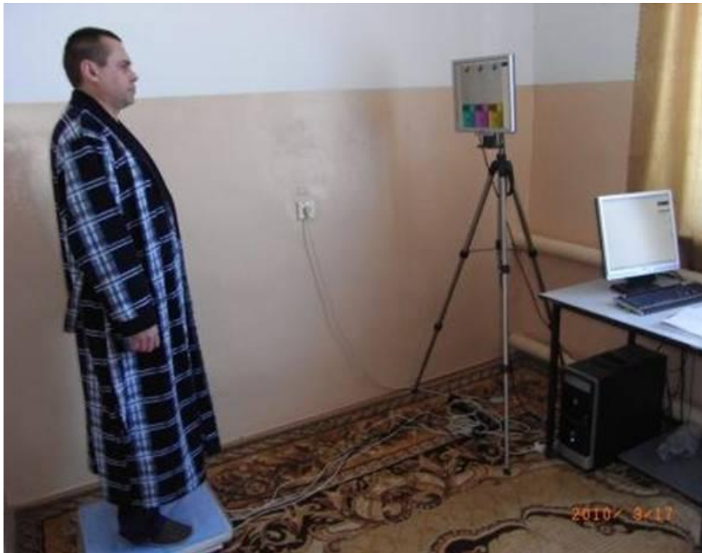
Fig.19. Stabilan 01-2, dispozitiv pentru evaluarea rapidă a stării psihofiziologice a unei persoane în stare pre-control
