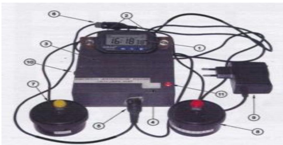
Fig. 6. Aparat DR-1 (dispozitiv pentru măsurarea diferitelor reacții)
