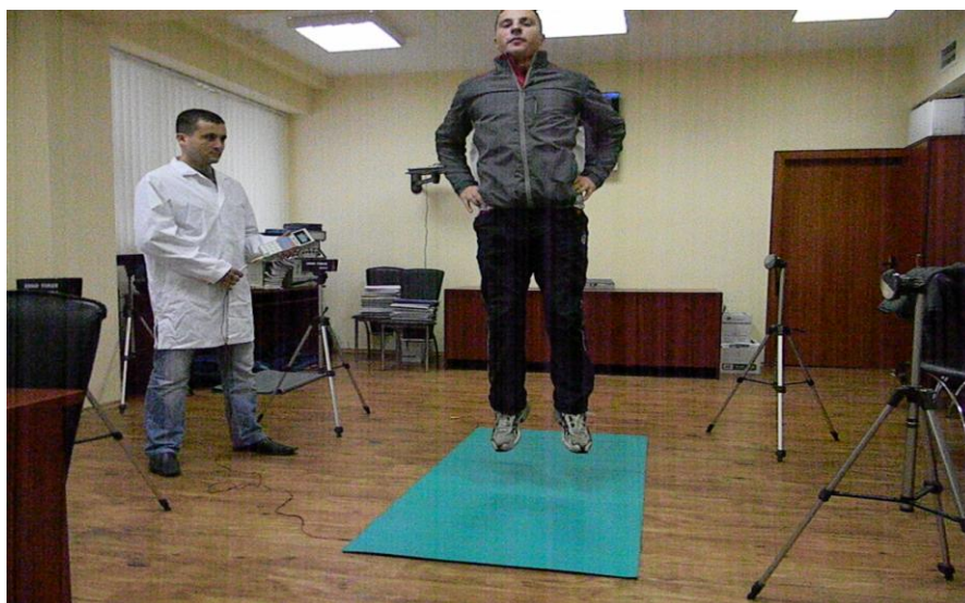
Fig.17. Ergometru: forța, frecvența, înălțimea săriturilor
