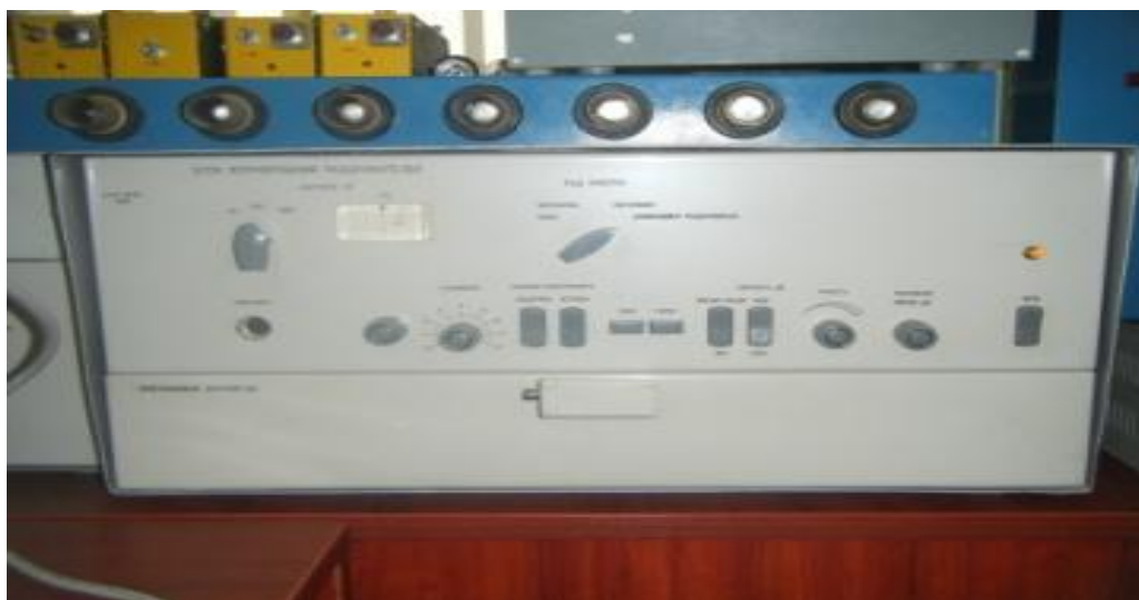
Fig. 5. Telecronoreflexometrul (dispozitiv pentru determinarea perioadei latente și motrice a reacției)
