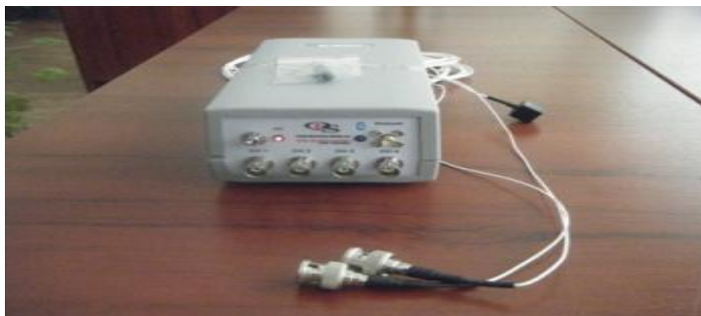
Fig.4. Accelerometru (dispozitiv pentru măsurarea mișcării centrului de masă al corpului)
